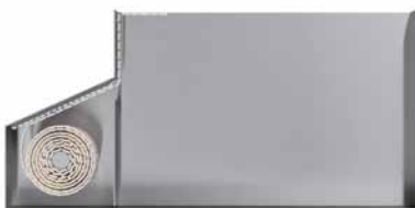
Roleta podwodna: dolna nisza Underwater poolcover: lower niche
